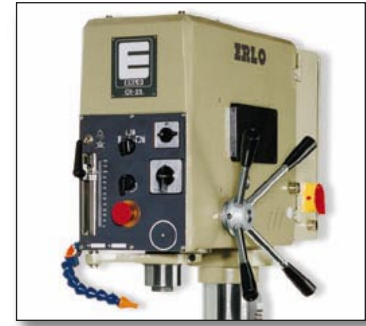
Inversión para roscado Turning for tapping Inversion pour taraudage Umkehrvorrichtung für Gewindeschneiden
